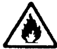
RIESGO DE INCENDIO MATERIAL COMBUSTIBLE
